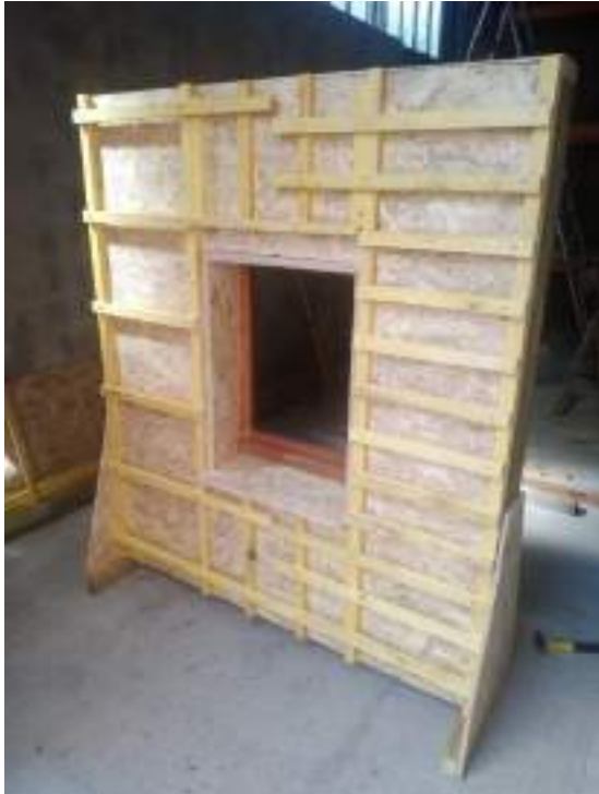
Photographies 1 : Maquette d'entourage de baie pour tuiles plates et tuiles à emboîtement. Ce traitement permet d'isoler la baie des contraintes liées
