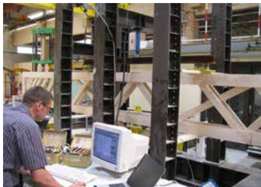
Essai de résistance en flexion de la charpente de la Salle Polyvalente de Lezennes (59). ARCHITECTE : LAURENT BAILLET, BET : INGÉBOIS STRUCTURES, ENTREPRISE BOIS : AS BOIS
