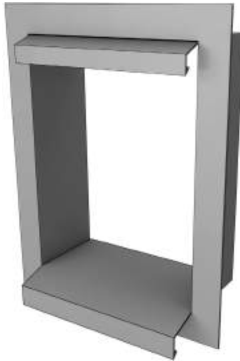
Figure 25 : Exemple de précadre étanche soudé
