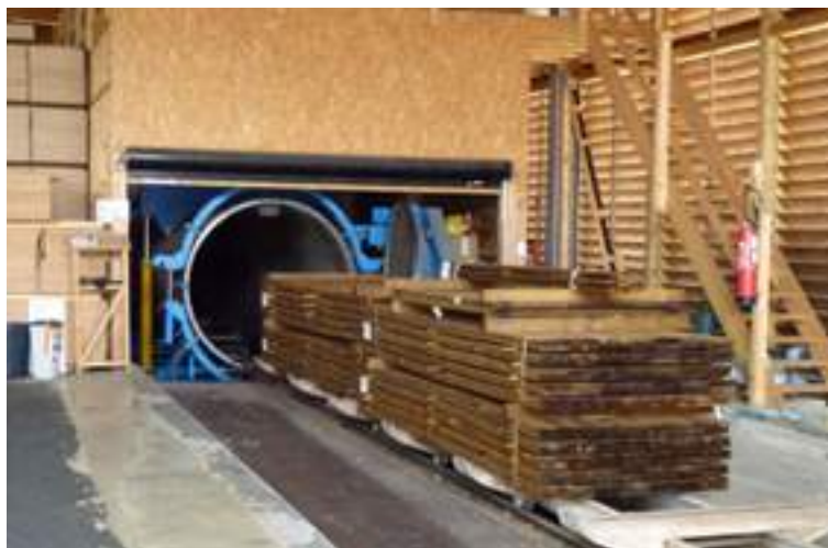
Autoclave de traitement - Entreprise Escaffre à Terssac (81)
