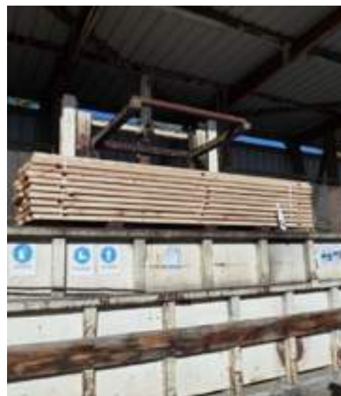
Bac de trempage - Entreprise Arbonis à Peguilhan (31)
