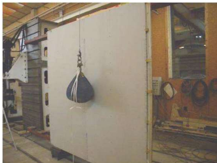
Photo 1 : Mur sur banc d'essai avec corps de chute « M50 »
