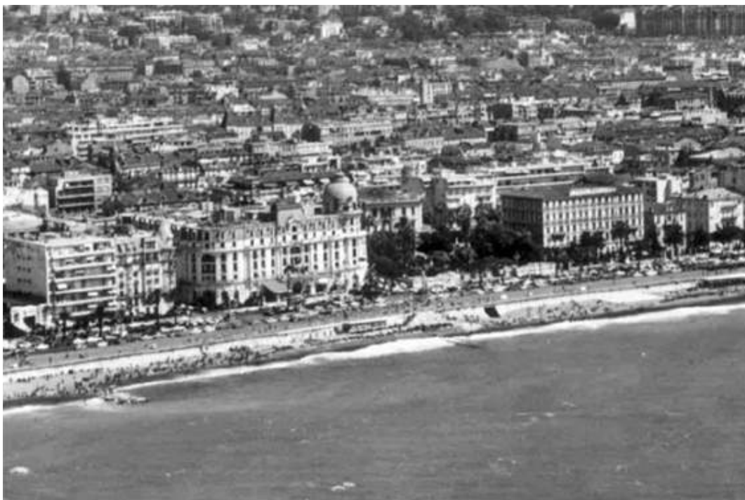
▲ Figure 72 : rugosité 0 (front de mer)
