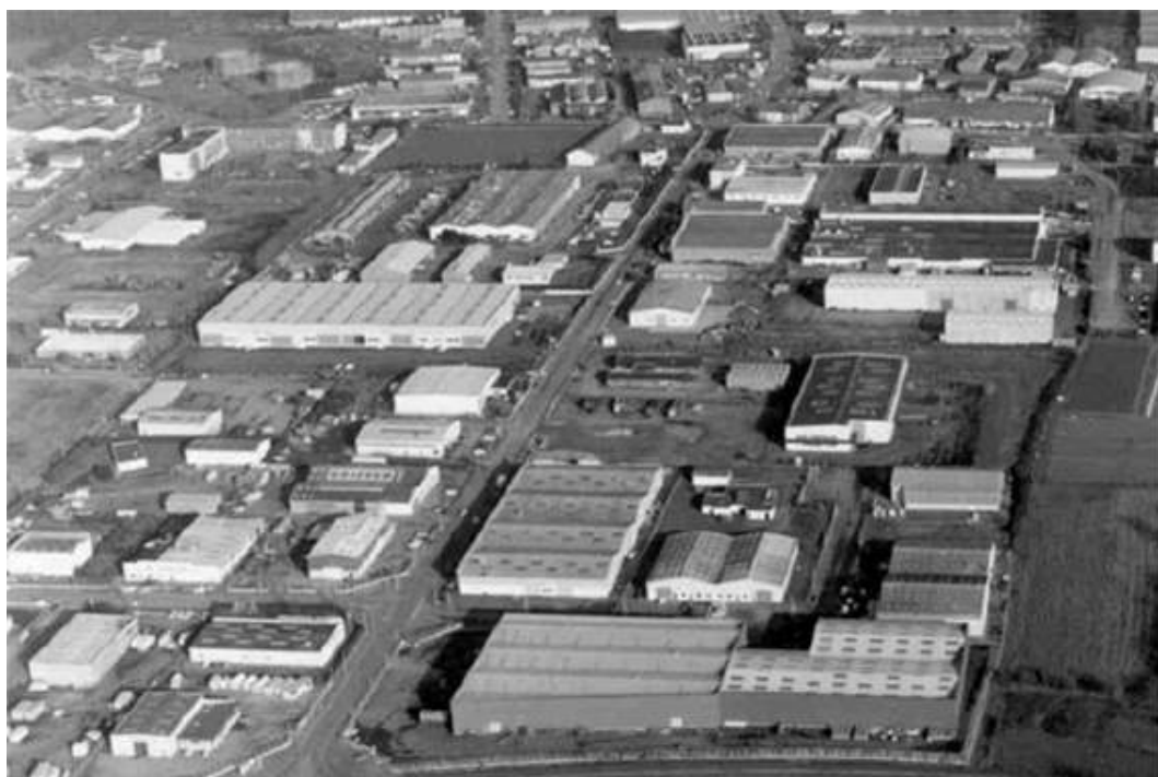
▲ Figure 77 : rugosité IIIb (zone industrielle, zone pavillonnaire)
