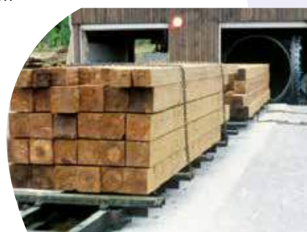
Procédé de traitement des bois par autoclave
