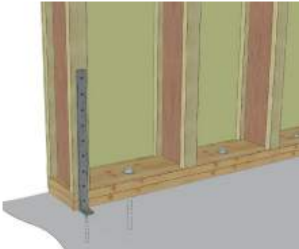
Figure 20 Ancrages sur dalle béton, mur ouvert
