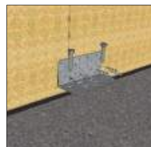
Figure 14 – Mise en œuvre d'une équerre de reprise du glissement au droit de la jonction de 2 panneaux de mur, pour assurer notamment la continuité mécanique des traverses basses
