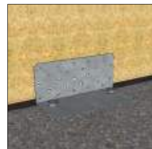
Figure 11 – Approche du panneau de mur LogiWall® / Guidage et mise en position des panneaux de mur en appui contre les équerres de reprise du glissement
