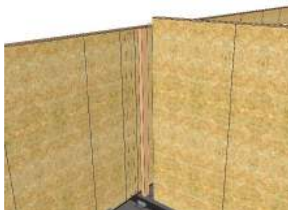
Figure 16 – Mise en œuvre d'un montant de raccord permettant l'emboîtement du mur de refend / Couturage au droit des plaques de parement
