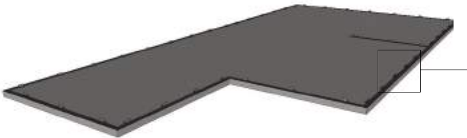
Figure 9 – Réception du support béton / Déroulage de la bande d'arase en périphérie et aux droits des refends / Fixation des équerres de reprise du glissement, servant également de guidage lors de la pose des panneaux de mur
