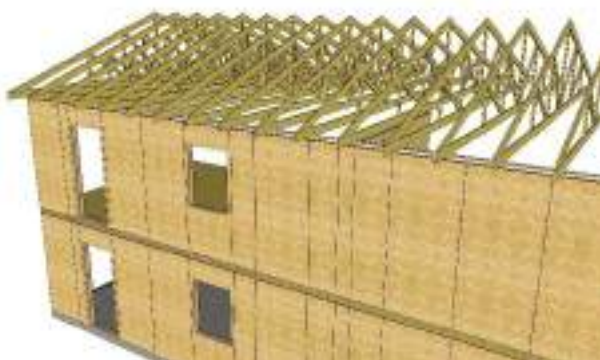
Figure 23 – Mise en œuvre d'une charpente de type fermettes
