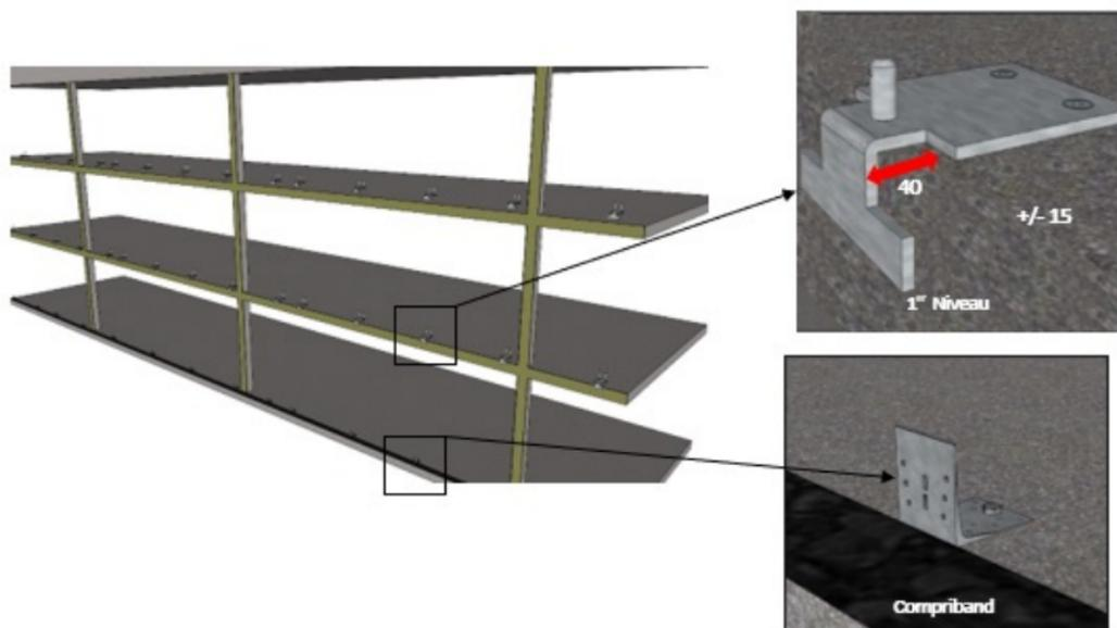
Pose des équerres métalliques en pied de façade et des platines support du système d'ancrage LogiFix® en bord de plancher (réglage de l'aplomb de la façade)
