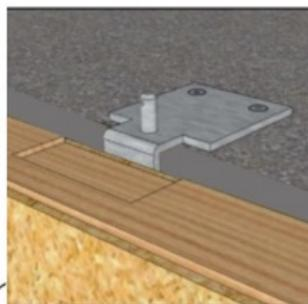
Mise en butée du panneau contre le plat vertical de la platine support
